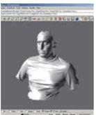
El proceso de escaneado es simple, consistiendo en recorrer con la cámara del scanner por alrededor del objeto, capturándolo desde varios ángulos. Luego a través de software, automáticamente se combinan todos los cuadros escaneados fusionándolos en el archivo digitalizado 3D, con una resolución de 0.2mm y una precisión de 0.02mm.
