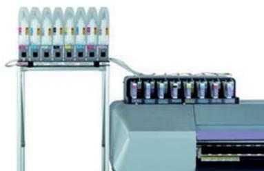
Las 8 líneas que tiene el cabezal cuentan, cada una, con 180 inyectores, ello permite alta precisión; incluso textos de cuerpo 4 se muestran claros y con detalle.
