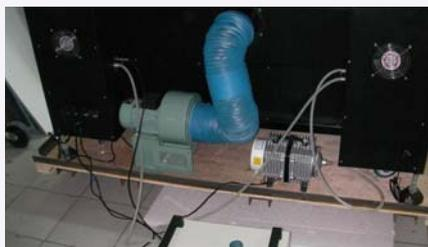
En esta imagen podemos ver la parte trasera en la cual se aprecia la "refrigeración o enfriamiento de lámpara láser" mediante agua y aire.
