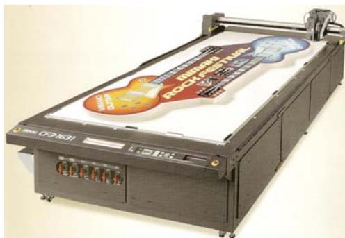
valor agregado, estando disponibles modelos de corte Recíproco y corte Tangencial. Los modelos de cortadores recíprocos permiten cortar cartón corrugado y materiales gruesos suaves utilizando un cortador oscilante y los modelos de cortador tangencial vienen con dos herramientas de corte tangenciales para cortar varios materiales desde blandos hasta rígidos con una fuerza de corte de hasta 5kg. Estos cabezales de corte puede cambiar el usuario.
