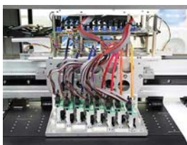
8 cabezales (C-M-Y-K, 2 por color).
