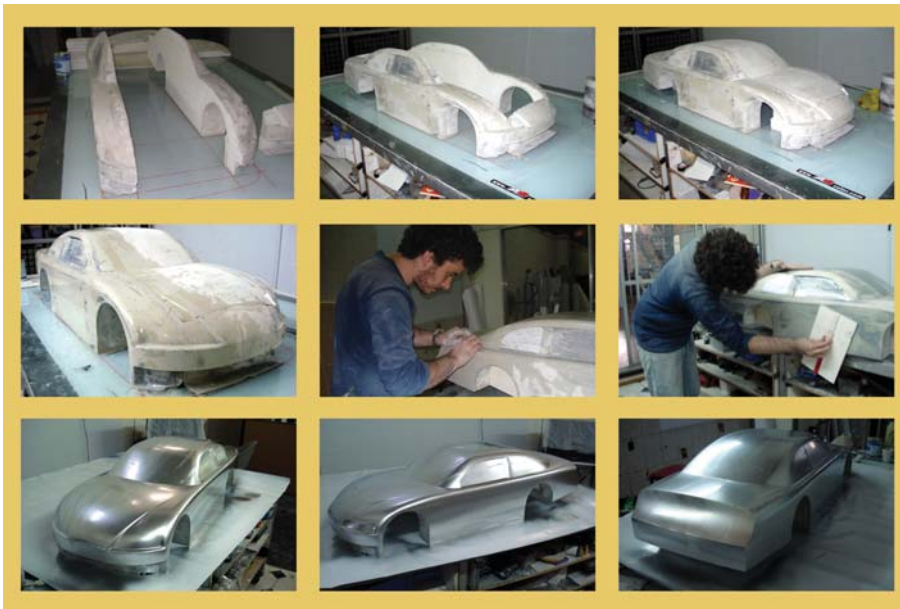
Routeado de la carrocería en poliestireno expandido.
