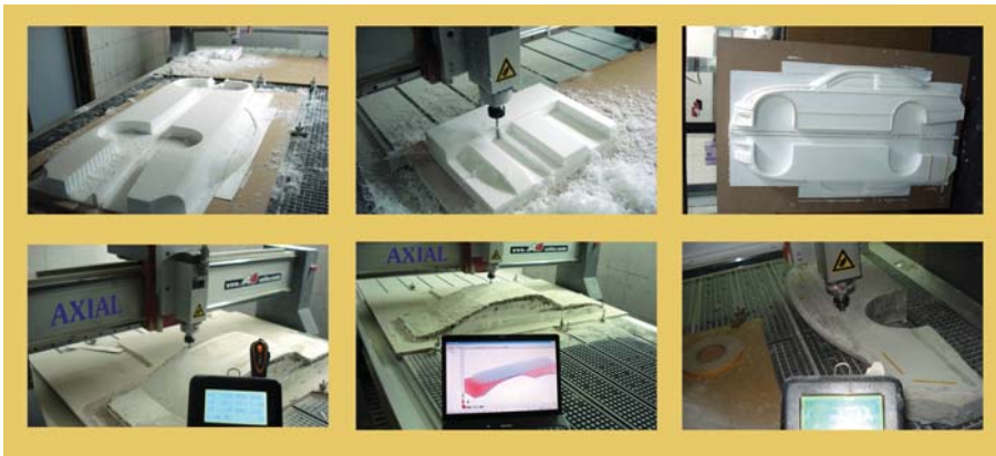
Routeado de la carrocería en poliestireno expandido.
