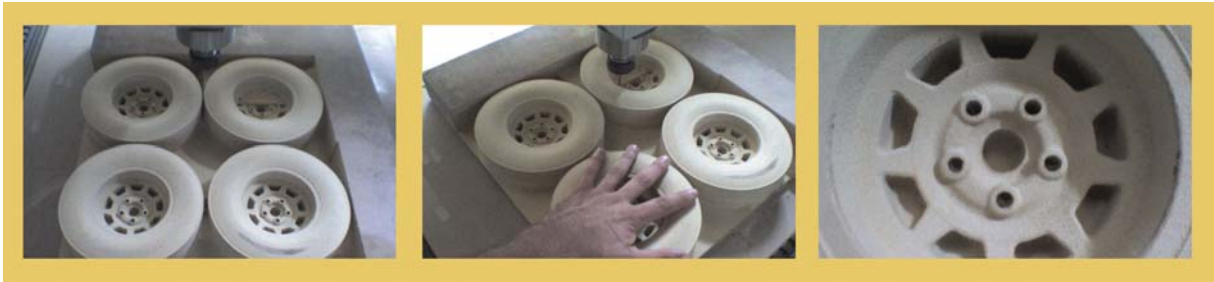
Fresado de las ruedas del automóvil sobre placas de MDF.
