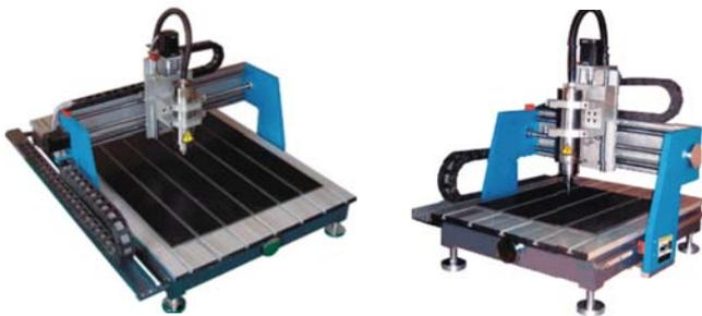
fresado de 2HP, con inversor de frecuencia. Estructura de hierro. Transmisión por piñón y cremallera con motores stepper y guías lineales de precisión. Control de mano por medio de consola. Incluye software para mecanizado y software Type3 para diseño 3D.
