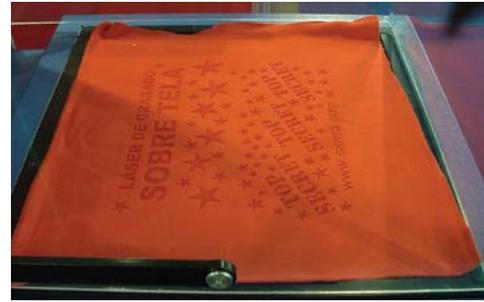
con alta precisión y controlado por un software avanzado; ello permite resolver detalles con amplia flexibilidad, segura precisión, gran estabilidad, total eficiencia y por sobre todo gran calidad. La potencia del láser y la velocidad de grabado pueden programarse en el instante previo a la producción del trabajo, y poder así lograr grabar a profundidades exactas y a altísimas velocidades.
