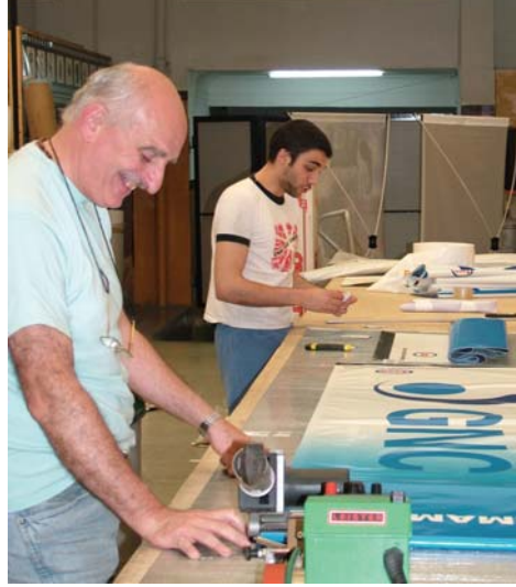
Personal técnico de Duckfeet en plena tarea de soldado de una gigantografía.
