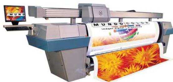
**Equipo JETi de impresión digital con tintas al solvente de reciente adquisición.**
