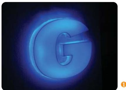
**1. Frontlight Letters:** Modelo a construir con cuerpo metálico, fondo cerrado y frente luminoso. La luz de neón se coloca en el interior y se refleja a través de la placa de acrílico que lleva al frente. Aceptan tipografías de acuerdo al texto que se explica en esta nota.
