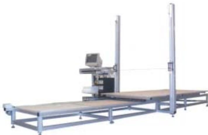
**Mesa de trabajo. Puede apreciarse la cama donde descansa el material desplazada sobre el eje horizontal y el alambre tensado que se desplaza sobre el eje vertical.**
