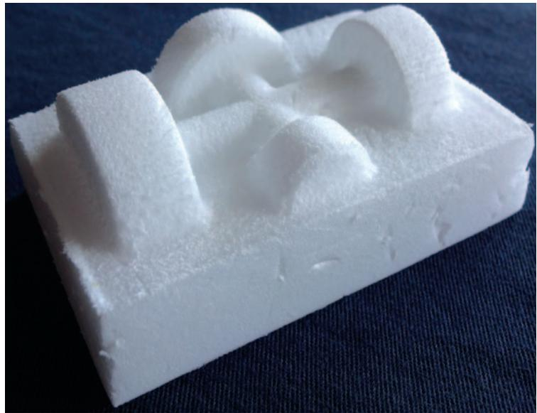
Modelo 3D mecanizado con CNC-Router sobre poliestireno desde *software* CAD-CAM. Los router provistos con sistemas abiertos brindan al usuario la posibilidad de elegir el *software* a utilizar al no traer uno instalado de fábrica.
