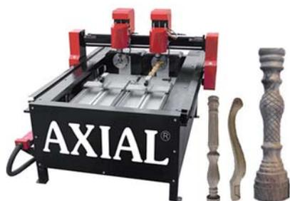
para regular la profundidad de trabajo hasta 600mm, motores stepper de micropaso en todos los ejes. Precisión 0.05mm. Resolución 0.005mm. También puede usarse como router Standard de 900x1800x130mm útiles.
