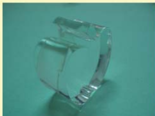
Corte de Acrílico de 24mm. con láser en una sola pasada.
