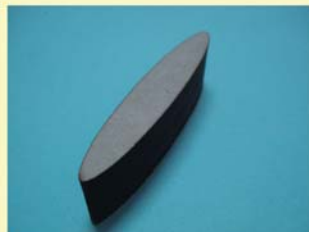
Corte de MDF de 18mm. con láser en una sola pasada.
