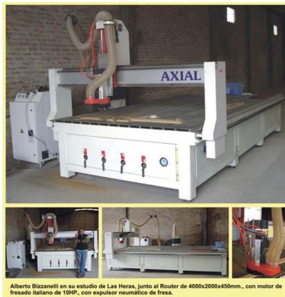
Alberto Bizzanelli en su estudio de Las Heras, junto al Router de 4000x2000x450mm., con motor de fresado italiano de 10HP, con expulsor neumático de fresa.
