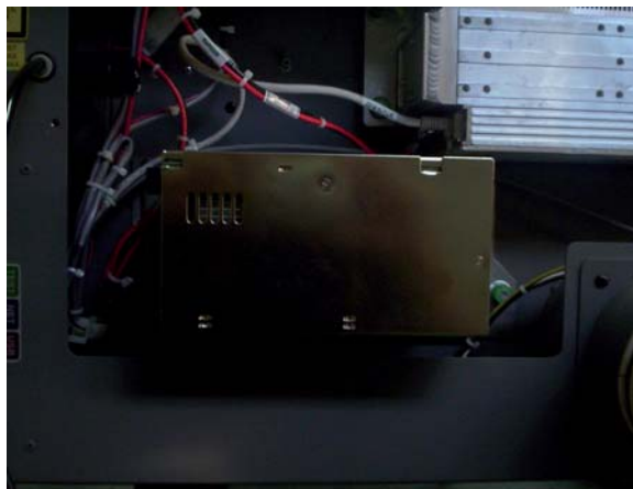
Grabadora láser con fuente de alimentación interna.
